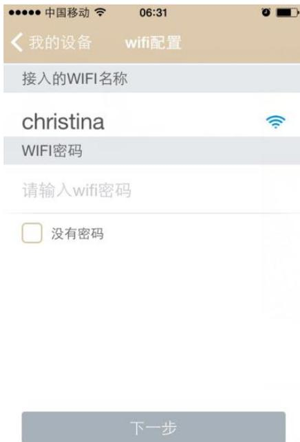
第二步，在听到语音提示“请将手机靠近摄像机”的提示时，把手机靠近摄像机5cm元，手机喇叭对着摄像机，手机将会向摄像机发送音频。摄像机收到音频文件后，语音提示“开始配置网络”，等网络配置成功后，摄像机语音提示“网络配置成功”。
